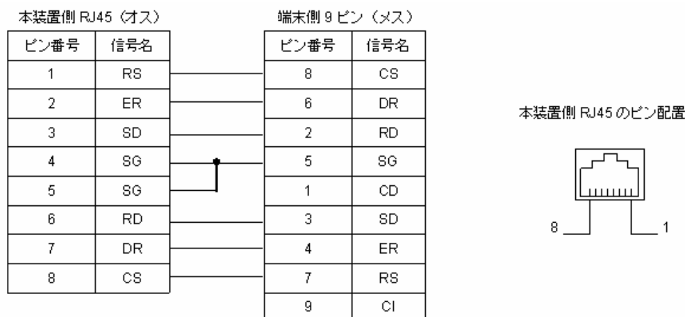
図 C-1 運用端末接続ケーブル・ピン配置（RJ45 － D-sub 9 ピン）
