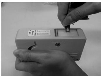
図 A-5 フェルール端面の清掃
