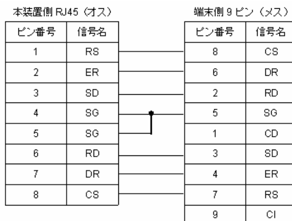
図 C-1 運用端末接続ケーブル・ピン配置 (RJ45 – D-sub 9 ピン)
