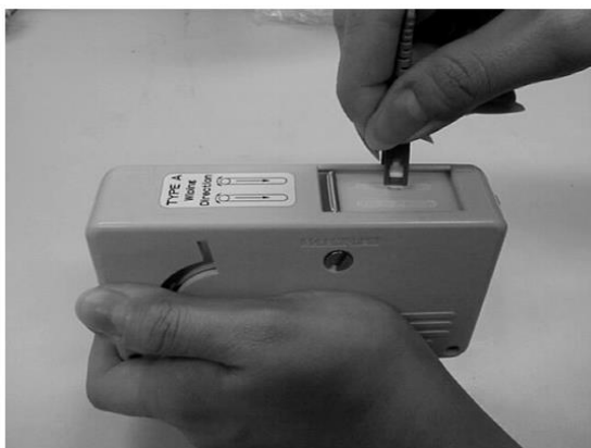
図 A-3 フェルール端面の清掃
