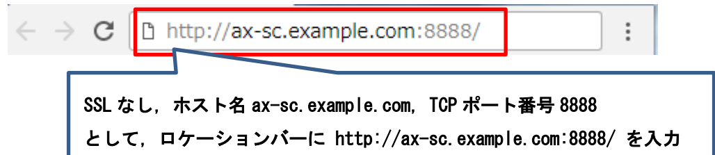
図 5-3 AX-Security-Controller (Tracker) へのアクセス例
