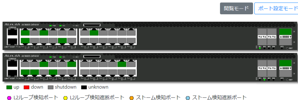
図 4-104 機器詳細画面（フロントパネル）の表示
