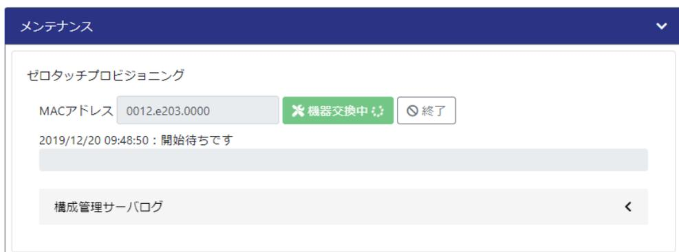
進捗状況が開始待ちから、機器の起動待ちになったことを確認してから、交換対象機器を交換機器に入れ替えて電源を入れて起動させます。
