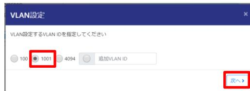
選択した VLAN ID のポート状態と VLAN 設定状態が表示されます。
