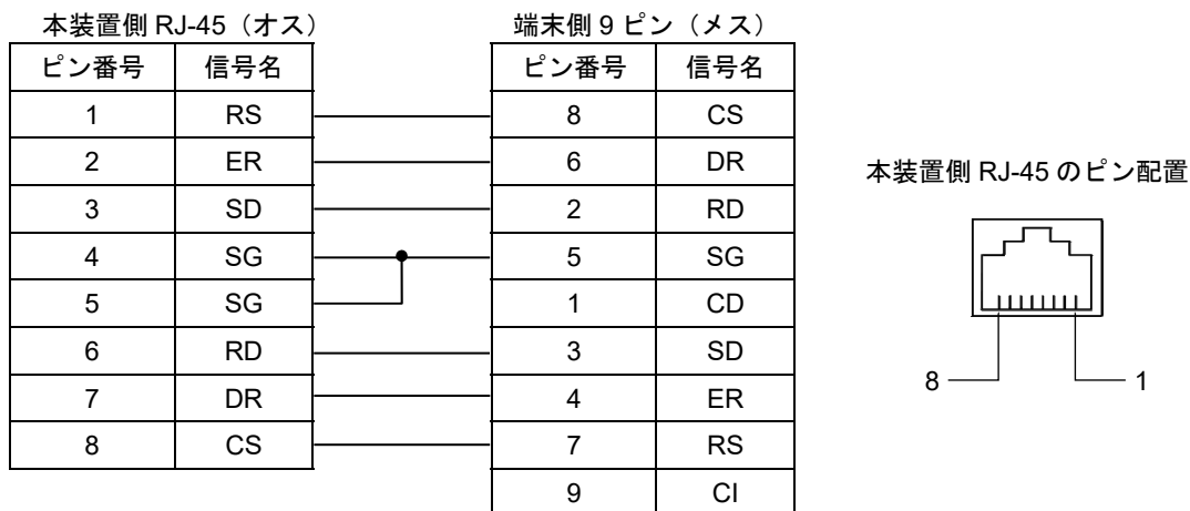
図 1-2 運用端末接続ケーブル
