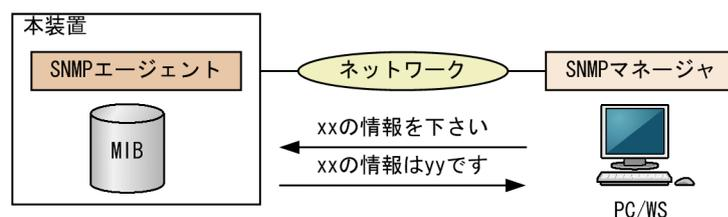
本装置の運用コマンドには MIB 情報を表示するための SNMP コマンドがあります。このコマンドは、自装置およびリモート装置の SNMP エージェントの MIB を表示します。
