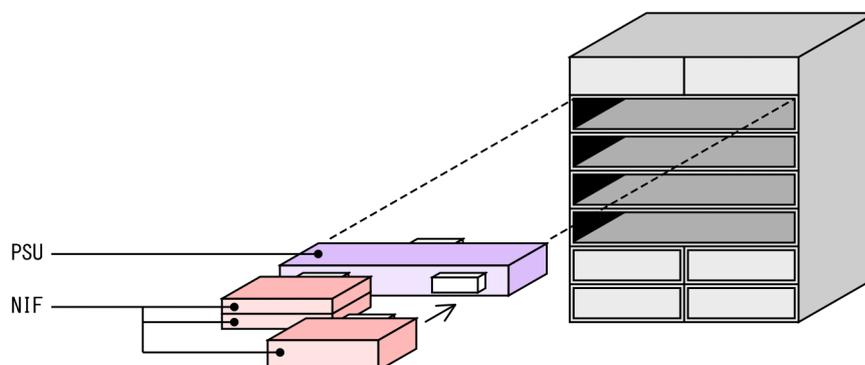
NIF の搭載構成を次の図に示します。
