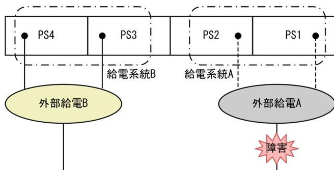
外部給電系統には 2 系統あり、それぞれの系統に接続できる PS は搭載位置が決まっています。給電系統冗長での PS の搭載位置を次の表に示します。
