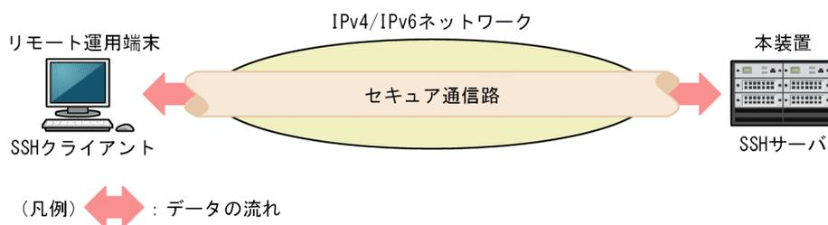
本装置の SSH クライアント機能によって、セキュア通信路を使用して本装置から SSH サーバへのログインやファイル転送を実現できます。本装置から SSH サーバへの接続例を次の図に示します。
