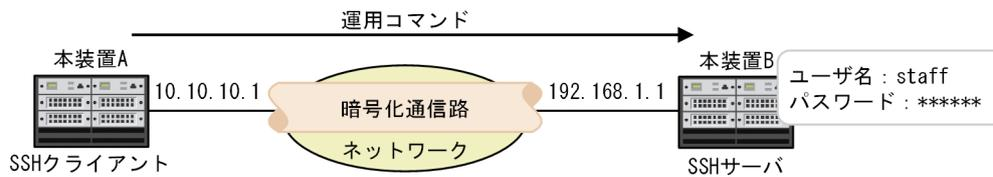
本装置 A から本装置 B 上で運用コマンドを実行する例を次の図に示します。本装置上で運用コマンドを実行するときには、強制的に仮想端末を割り当てるように、クライアント側でパラメータを指定する必要があります。一般的な SSH の実装では、ssh コマンドの `-t` パラメータを指定します。次の図に示す例でも、本装置 A の運用コマンド ssh に `-t` パラメータを指定します。
