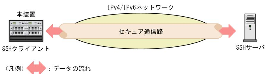
また、本装置は SSH サーバと SSH クライアントの両方をサポートしているため、セキュア通信路を使用し、本装置から別の本装置へのログインやファイル転送を実現できます。本装置から別の本装置への接続例を次の図に示します。
