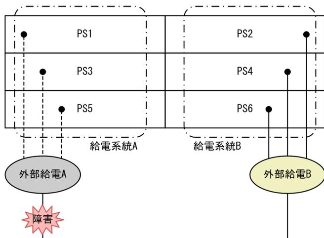
また、AX8300S の給電系統冗長の構成例を次の図に示します。図は AX8308S を背面から見たものです。AX8304S は正面から見て左から PS1, PS2, PS3, PS4 の順に並びます。
