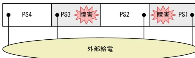
AX8304S は 1 個または 2 個の PS で運用できます。4 個の PS を搭載した構成で運用に必要な PS が 1 個の場合は、3 個の PS に障害が発生しても運用を継続できます。同様に、4 個の PS を搭載した構成で運用に必要な PS が 2 個の場合は、2 個の PS に障害が発生しても運用を継続できます。
