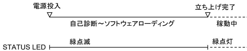
1. 電源投入後，STATUS LED が緑点滅し自己診断およびソフトウェアローディングを開始します。
