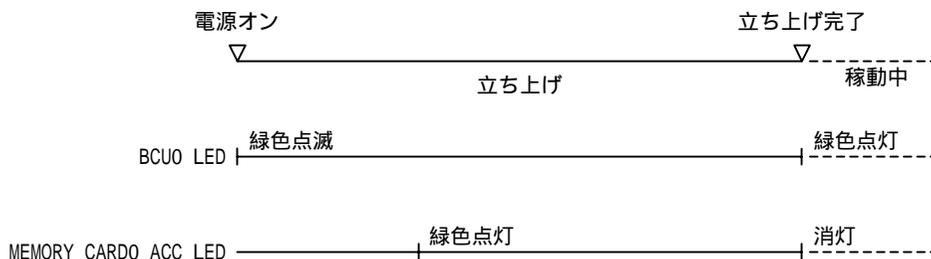
1. 電源投入後、装置正面パネルの BCU0 LED が緑色に点滅し、立ち上げ処理を開始します。（BCU を 2 重化している場合、BCU0 LED および BCU1 LED が緑色に点滅します。）
