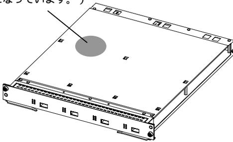
装置の電源を入れたままでRB2-10G4RXを取り外す場合は、RB2-10G4RXを閉塞してから5分後に取り外してください。
