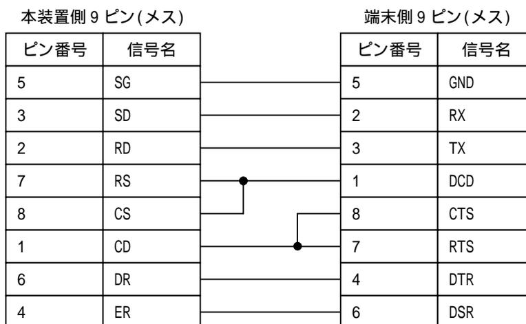
図 1-2 RS-232C クロスケーブルのピン配置
