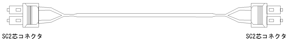
図 3-20 OC - 192c POS 用シングルモード光ファイバケーブル (コア径 10\mu\text{m} ) の概略図
