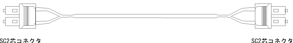
図 3-6 1000BASE - SX / 1000BASE - LX 用マルチモード光ファイバケーブル（コア径 50 \mu\text{m} ）の概略図
