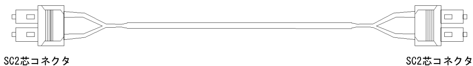
図 3-10 10GBASE - ER / 10GBASE - EW 用シングルモード光ファイバケーブル (コア径 10 \mu\text{m} ) の概略図
