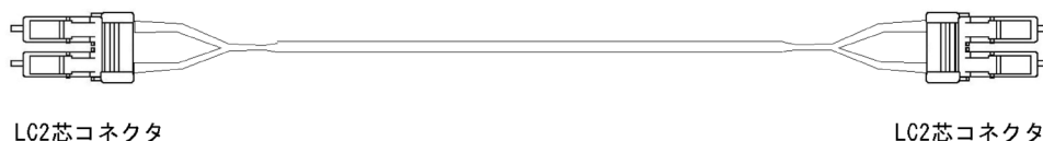
図 3-4 1000BASE - LX / 1000BASE - LH 用シングルモード光ファイバケーブル (コア径 10 \mu\text{m} ) の概略図
