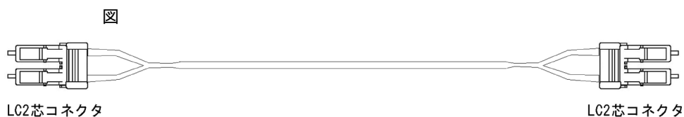
図 3-13 10GBASE - SR 用マルチモード光ファイバケーブル（コア径 50 \mu\text{m} ）の概略図
