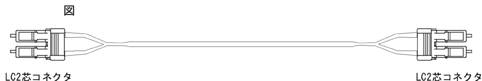
図 3-21 OC - 48c POS 用シングルモード光ファイバケーブル (コア径 10 \mu m) の概略
