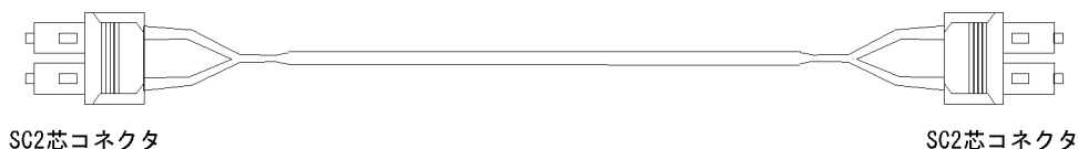
図 3-7 1000BASE - SX / 1000BASE - LX 用マルチモード光ファイバケーブル (コア径 62.5 \mu m) の概略図
