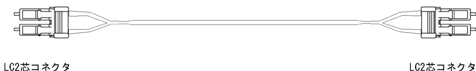
図 3-5 1000BASE - LH シングルモード光ファイバケーブル (コア径 8\mu\text{m} ) の概略図
