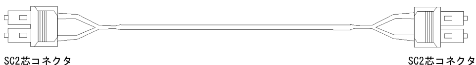
図 3-4 1000BASE - LX / 1000BASE - LH シングルモード光ファイバケーブル (コア径 10 \mu\text{m} ) の概略図
