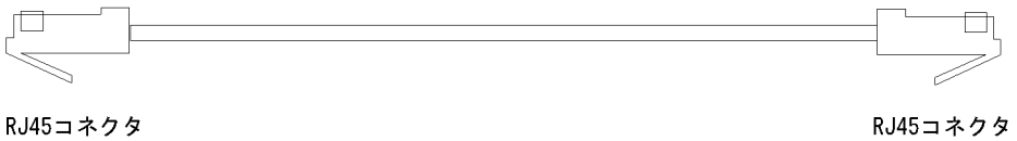
図 3-17 ツイストペアケーブル（クロスケーブル）の概略図
