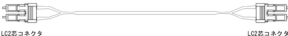
図 3-6 1000BASE - SX / 1000BASE - LX 用マルチモード光ファイバケーブル (コア径 50 \mu\text{m} ) の概略図
