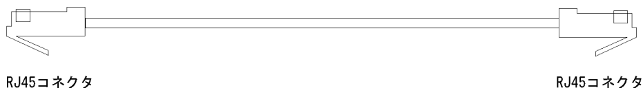
図 3-15 ツイストペアケーブル（クロスケーブル）の概略図
