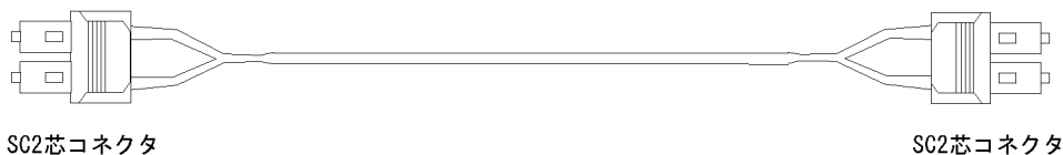
図 3-5 1000BASE - LH シングルモード光ファイバケーブル (コア径 8 μm) の概略図
