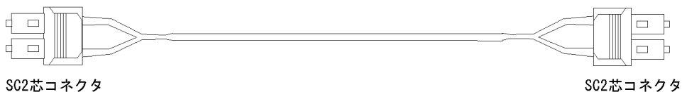
図 3-3 1000BASE - SX / 1000BASE - LX マルチモード光ファイバケーブル (コア径 62.5 μm) の概略図
