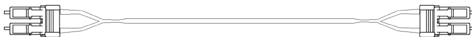
図 3-9 1000BASE - LH シングルモード光ファイバケーブル (コア径 8 \mu m) の概略図
