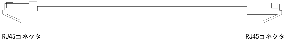
図 3-16 ツイストペアケーブル（ストレートケーブル）の概略図
