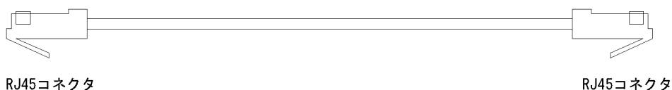
図 3-10 ツイストペアケーブル (ストレートケーブル) の概略図
