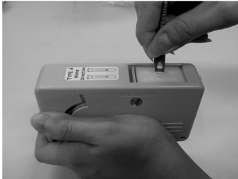
図 A-4 フェルール端面の清掃
