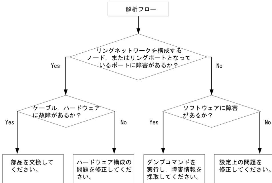
Ring Protocol 運用時に正常に動作しない場合、またはリングネットワークの障害を検出する場合は、該当のリングネットワークを構成するすべてのノードに対して、次の表に示す障害解析方法に従って、原因の切り分けを行ってください。
