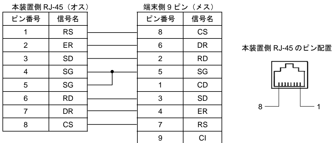
図 1-2 運用端末接続ケーブル
