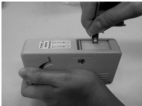
図A-3 フェルール端面の清掃
