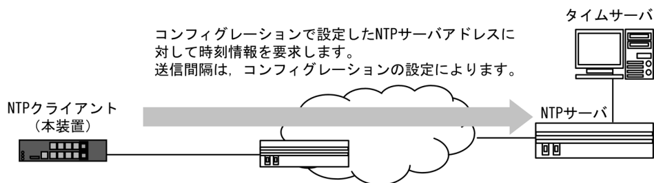
図 11-1 Unicast モードによる時刻情報取得図 (プライマリ設定時)
