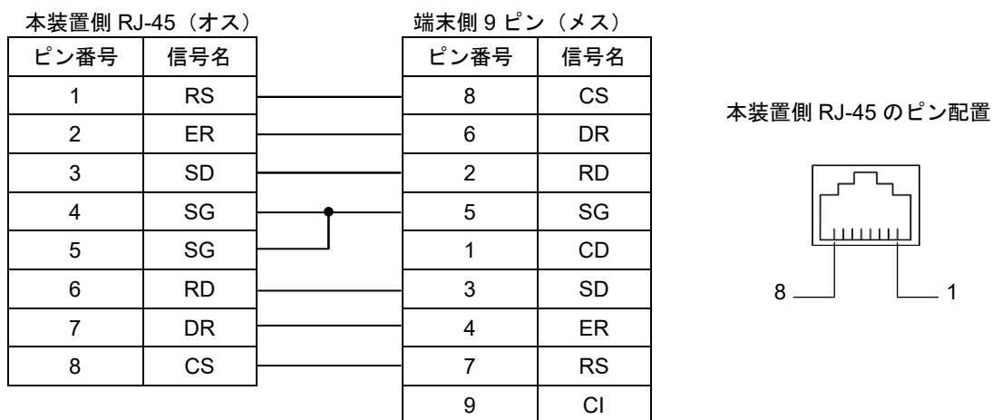
図3-1 運用端末接続ケーブル
