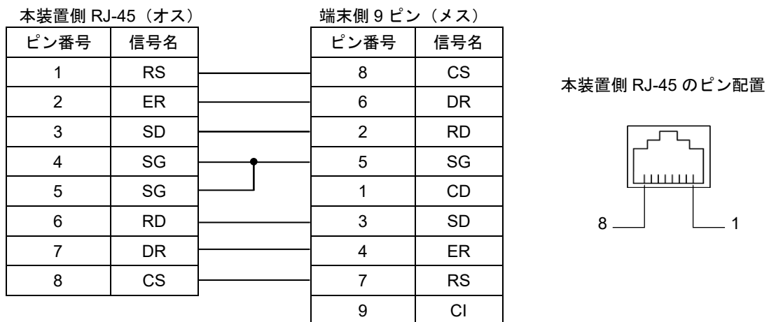
図3-1 運用端末接続ケーブル
