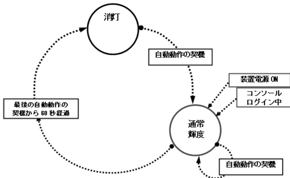
図 12-2 LED 自動動作の遷移【AX1250S】【AX1240S】
