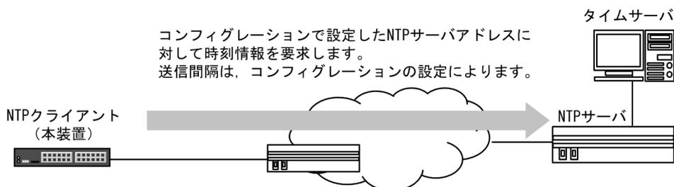
図 9-2 Unicast モードによる時刻情報取得図（プライマリ/セカンダリ設定時）
