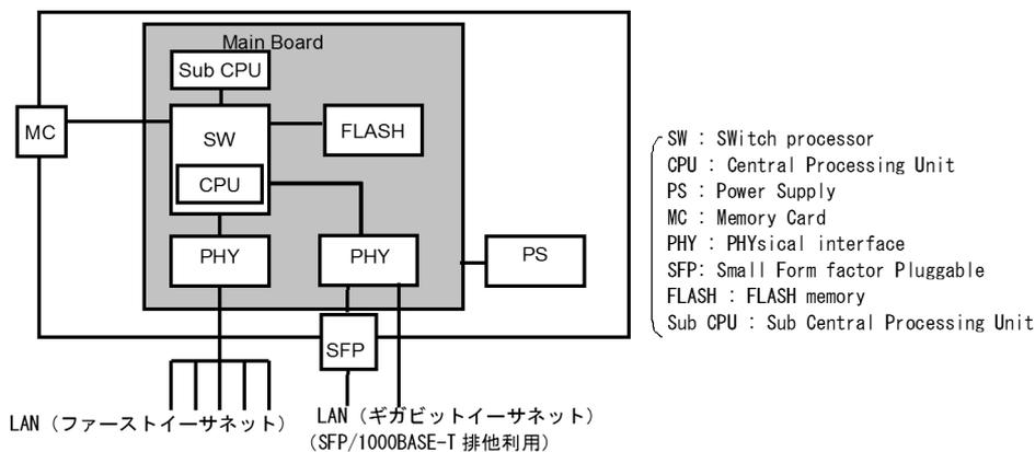
図 2-15 ハードウェアの構成 (AX1240S-24P2C モデル)
