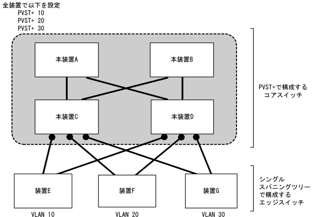
装置Eで障害が発生した場合、コアスイッチ側をPVST+で動作させているため、装置F、装置Gにトポロジー変更通知が波及しません。
