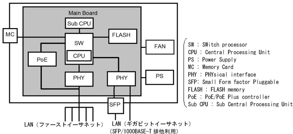
図 2-16 ハードウェアの構成 (AX1240S-48T2C モデル)
