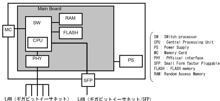
図 2-10 ハードウェアの構成 (AX2230S-24P モデル)
