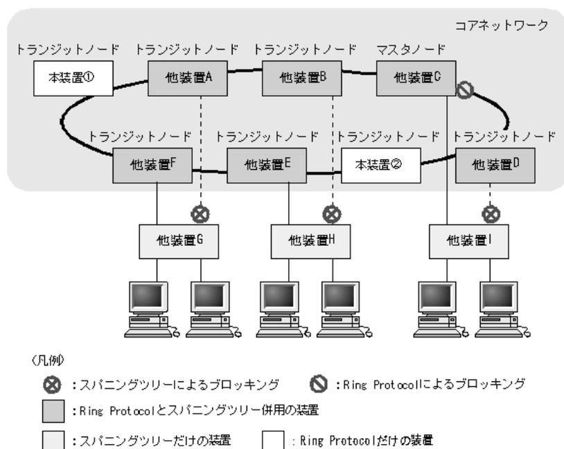
図 23-2 Ring Protocol とスパニングツリーの併用例と本装置の位置づけ (マルチリング構成)
