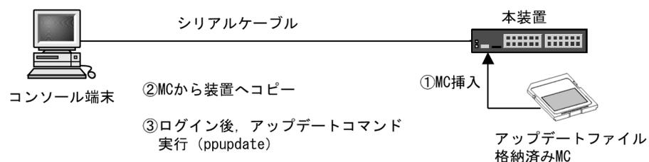
図 13-2 ソフトウェアのアップデートの概要 (ftp)
