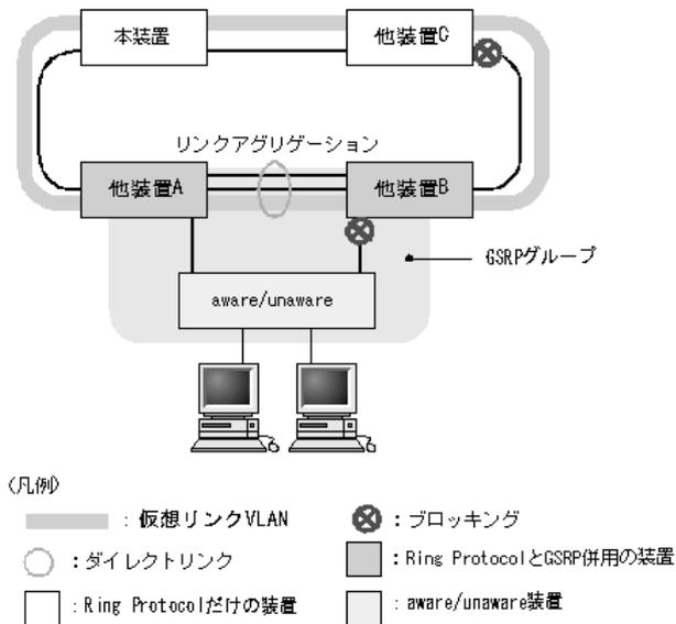
図 23-4 Ring Protocol と GSRP の併用例と本装置の位置づけ（ダイレクトリンクをリングネットワークで使用しない場合）
