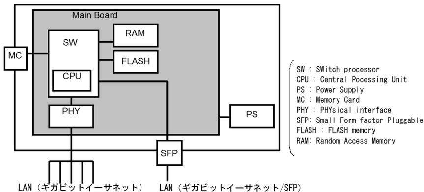
図 2-12 ハードウェアの構成 (AX2130S-24P モデル)
