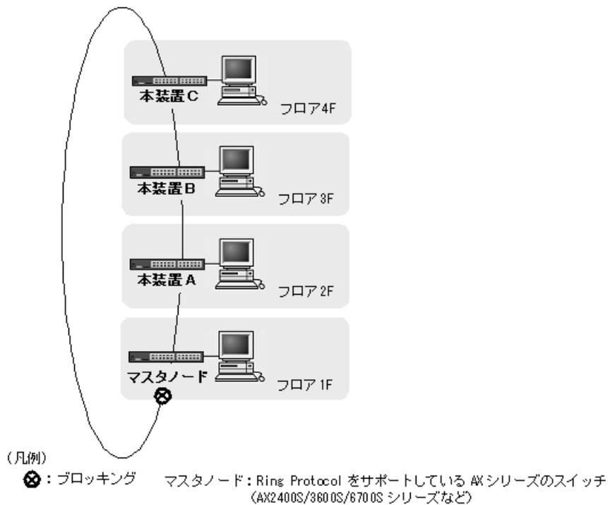
図 21-3 Ring Protocol の適用例（その 2）
