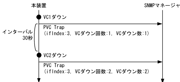
図 6-19 PVC Trap 動作例 (VC のダウン間隔がインターバルタイム以上の場合)
