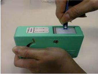
図 A-4 フェルール端面の清掃
