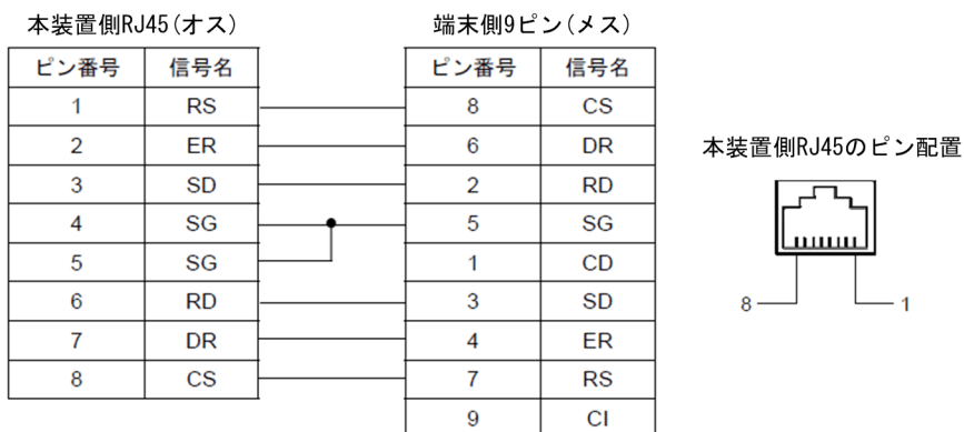
図 C-2 運用端末接続ケーブル・ピン配置 (RJ45 - D-sub 9 ピン)
