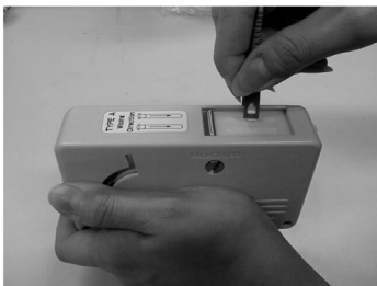
図 A-5 フェルール端面の清掃
