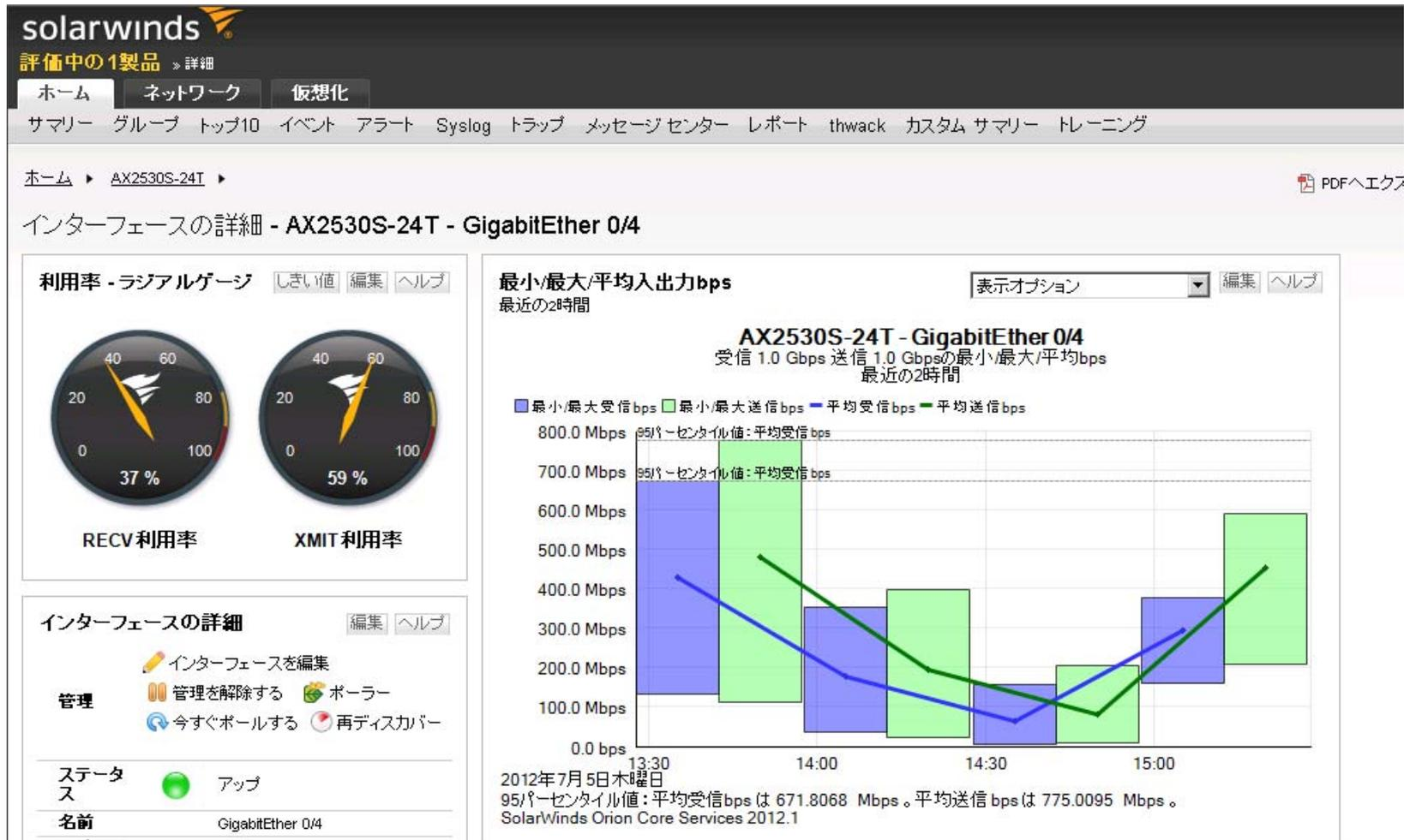
上図は、Orion NPMでAX2530Sの物理ポート(GigabitEther 0/4)の通信レート(bps)のグラフ表示例です。左側のメータは現在の回線使用率を示しています。(本例は最近2時間の表示例です)
