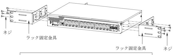
ネジを外して左右のラック固定金具を取り外す (製品シリーズにより、金具の形状やネジの本数は異なります。)
