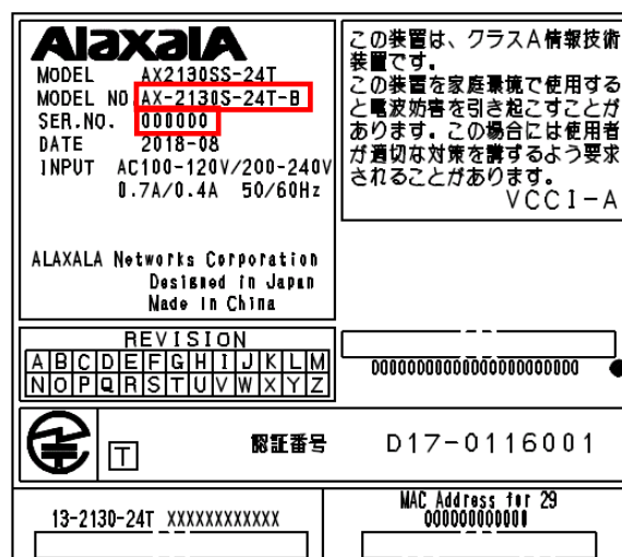
図 1-7. 機器ラベルの記載内容(AX-2130S-24T-B のパターン B)の例
