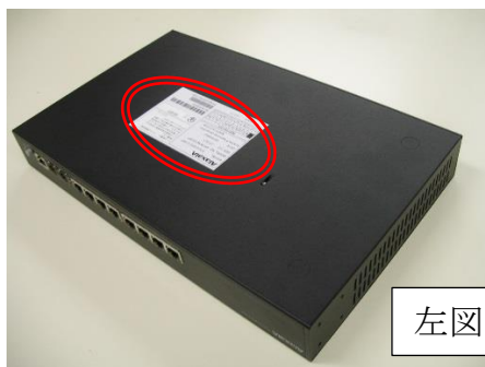
図 2-1. 装置底面の機器ラベルの貼付位置(AXPR-M210-08P)の例
