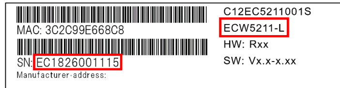
図 3-6. 機器ラベルの記載内容(AXprimoW ECW5211-L)の例
