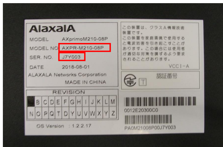
図 2-2. 機器ラベルの記載内容(AXPR-M210-08P)の例
