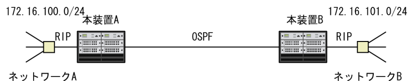
図 13-5 サブネット間の接続の例
