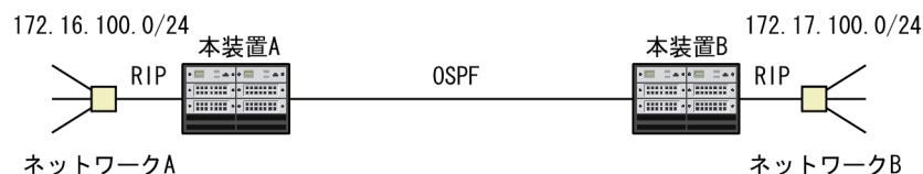
図 13-3 異なるネットワークアドレスのサブネット間の接続
