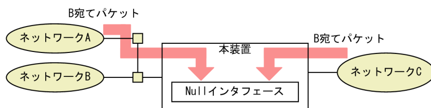
図 6-1 Null インタフェースネットワーク構成
